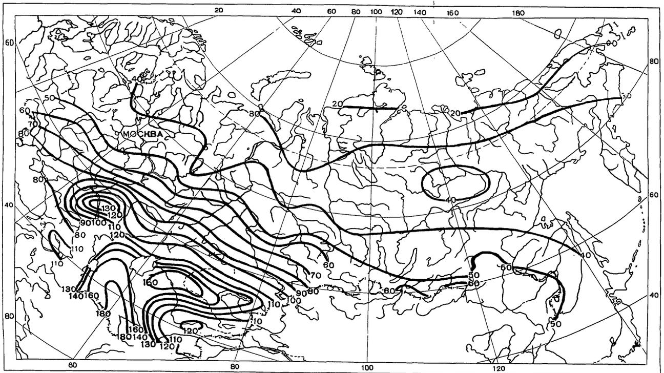
Рис. П.2.1. Средняя многолетняя величина испарения с водной поверхности испарительного бассейна площадью 20 м<sup>2</sup> (в см)
