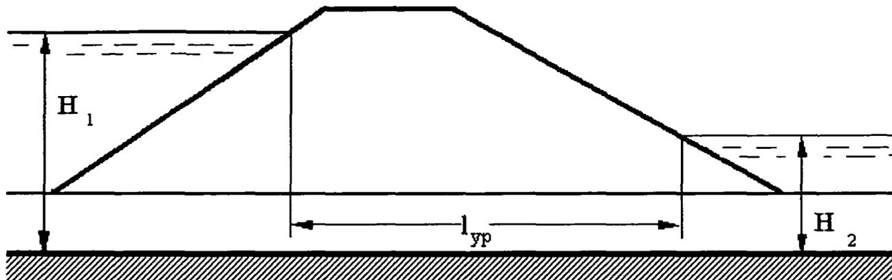
**Рис. 1.** Схема для расчета фильтрации через тело и основание грунтовой плотины
