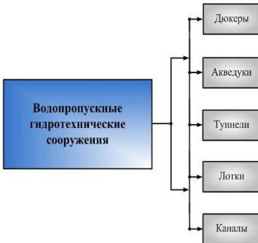
Рисунок 1 – Классификация водопропускных гидротехнических сооружений
